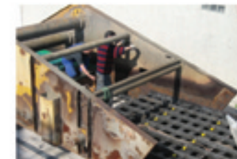
Austausch Geweberahmen im Kieswerk
